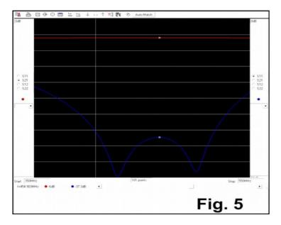
In **Figura 5** si può vedere il comportamento di un divisore a 4 uscite ma a Doppio Salto per la banda dei 430Mhz e subito si nota come la banda di utilizzo si sia estesa con il grafico che assume la tipica risposta a sella, cioè con una risalita a centro banda.
