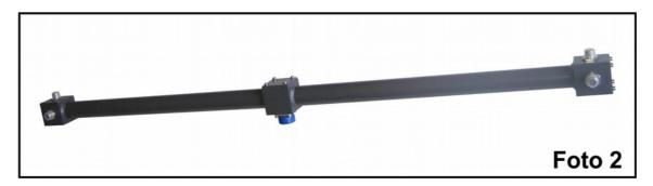
La **foto 2** si riferisce a un modello per i 144Mhz a 3+3 uscite con connettori di uscita N e con ingresso in 7/16 e quindi in grado di reggere con tranquillità 3 - 4KW di potenza.
